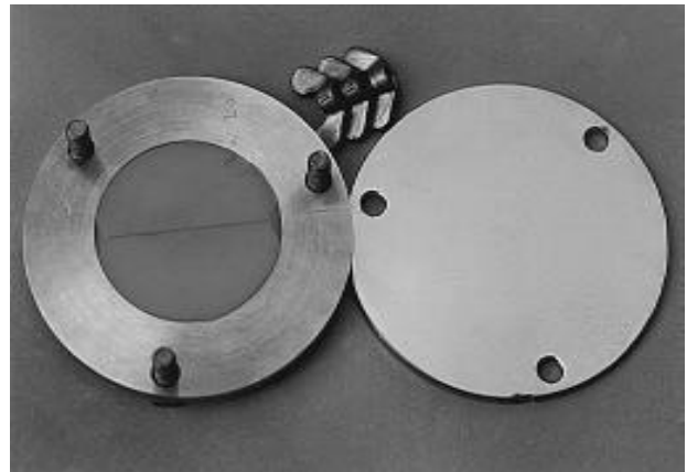
FIGURA 3 - Aspecto de uma das muflas aberta após polimerização da resina
