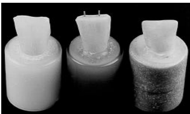
FIGURA 4 - A) dente bovino incluído por sua raiz no anel de plástico com resina especial que não desenvolve calor exotérmico; B) dente preparado com dois pinos para ser restaurado; C) dente restaurado
