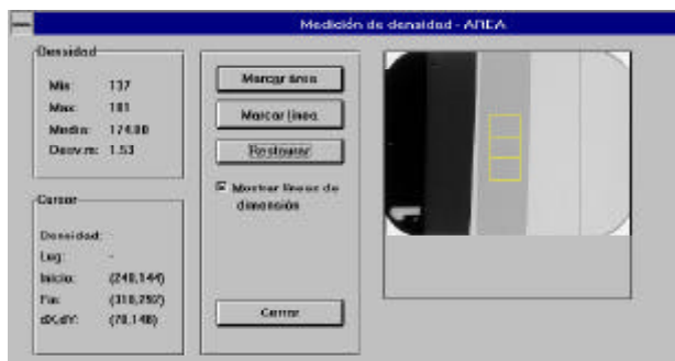
FIGURA 3 - Tela do programa Digora for Windows 1.51 que representa as medidas de densidade de uma área da tira de filme digitalizada, que fornece a Densidade Radiográfica e a Densidade Radiográfica invertida na área selecionada
