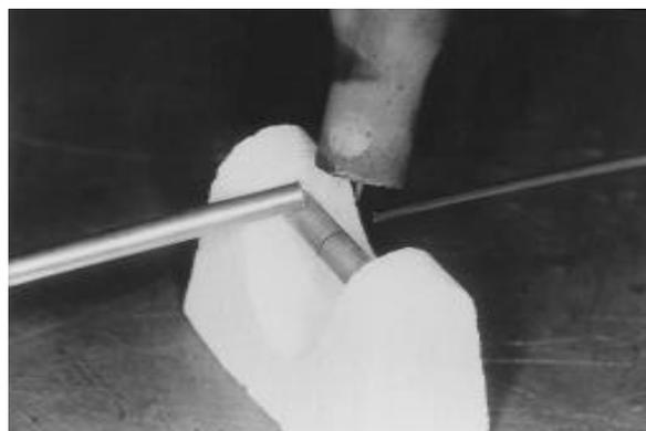
FIGURA 4- Eletrodo posicionado para soldagem pelo processo TIG
