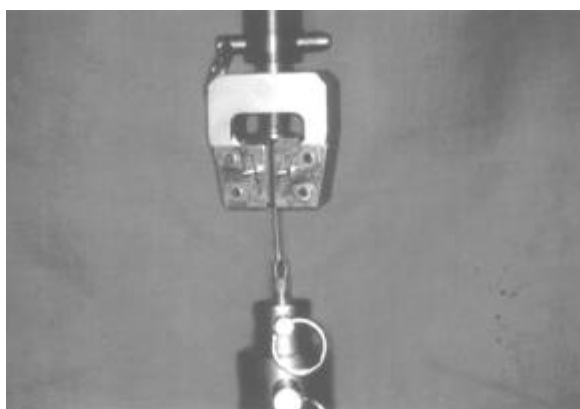
FIGURA 3- Uma alça de cera posicionada sobre a coroa para permitir a realização dos testes de tração.
