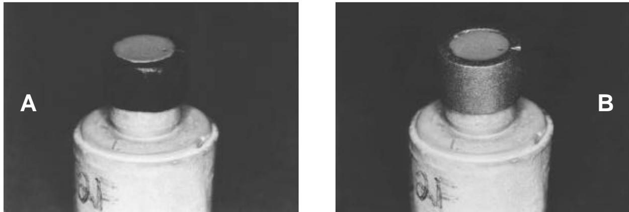
**FIGURA 3-** A- Vista do troquel de gesso obtido, com o respectivo padrão de cera. B- Elemento fundido resultante do processo de fundição.
