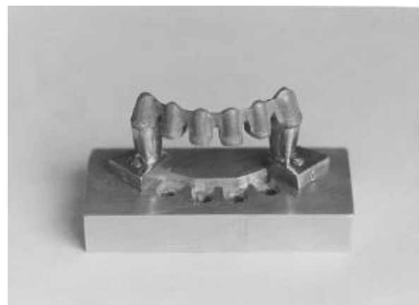
FIGURA 5 -Adaptação das infra-estruturas 43 e 33
